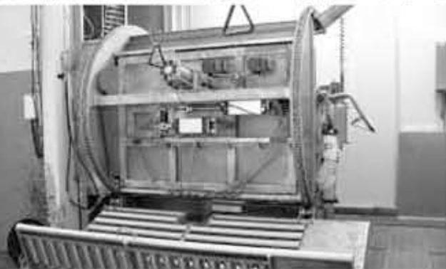
ゼンカイミートが使用している、回転式ノッキングベン
